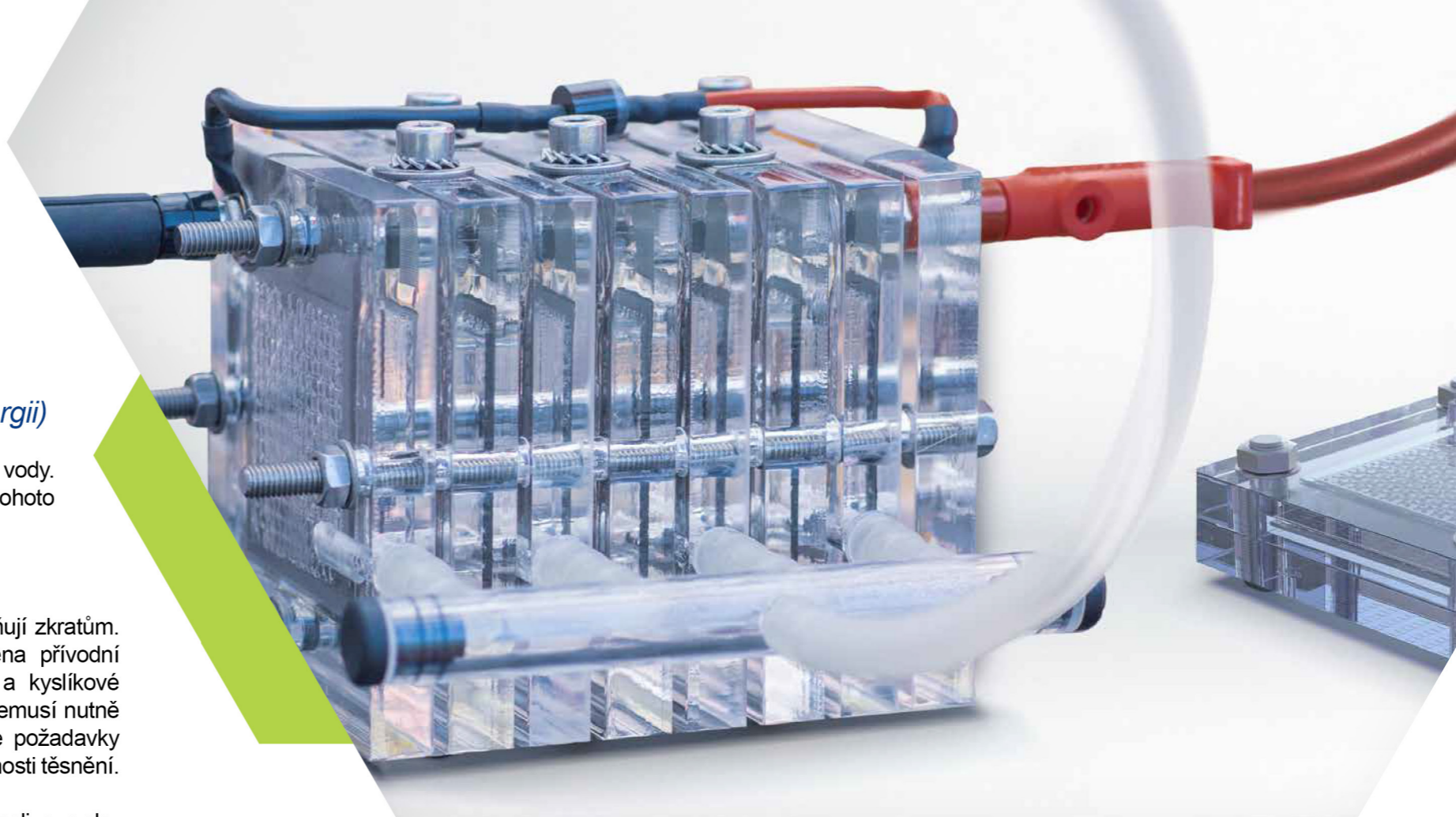
Zkušební palivové články v malém laboratorním měřítku pro běžně používané výzkumné účely.
